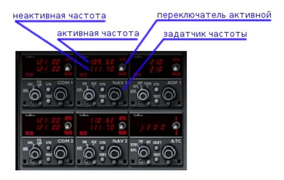
На рисунке выше показан пример приемника с двумя задатчиками частоты. Пользоваться им очень просто: при помощи круглого задатчика надо ввести требуемую частоту, а затем сделать ее активной при помощи переключателя. При наведении мыши на колесико задатчика курсор мыши меняет форму. Если он выглядит как маленькая стрелка, то при нажатии на мышь сменятся десятые доли. Если стрелка большая, то изменяться будет целая часть числа.
