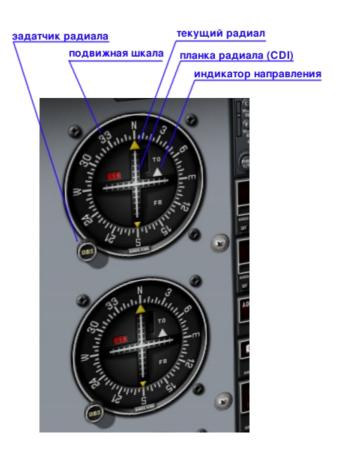
Прибор состоит из подвижной шкалы, напоминающей шкалу компаса, круглой ручки задатчика OBS, стрелки индикатора направления TO-FROM, транспаранта GS и двух планок, вертикальной и горизонтальной. Горизонтальная планка и транспарант GS используются при посадке по системе ILS и будут рассмотрены в отдельной статье.
