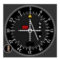
На рисунке видно, что при вращении ручки OBS шкала поворачивается, и верхний уголок показывает на номер текущего радиала. Как и на компасе, все номера на приборе пишутся деленные на 10, таким образом цифра 3 обозначает радиал 30.
